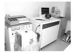
使用上の注意 ローターは高速で回転するため、ローターがアンパランスにならない ようサンプル量、サンプルチューブの挿入位置に注意して下さい。バ ランスの取れていないローターを回転させることは事故に繋がり危 険です。チューブに加えるサンプル量も遠心時のサンプルの状態を 想定して調節して下さい。ローター室は高真空になるため、ローター の蓋等が正しくセットされていない場合には、サンプルの噴出などが おこり、貴重なサンプルを失うと共に危険です。なお、使用に当たっ ては、備え付けのログブックに必要事項を記入してください。不明な 点は確認して下さい。
